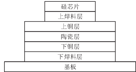
图 3 IGBT 模块垂直层状结构
